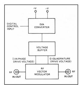
Fig. 1-Model 7928A, block diagram
