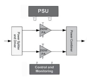
Fig. 2: SSPA 400W BLOCK DIAGRAM
