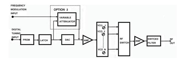
Fig. 1-Multi-Band DTO Block Diagram
